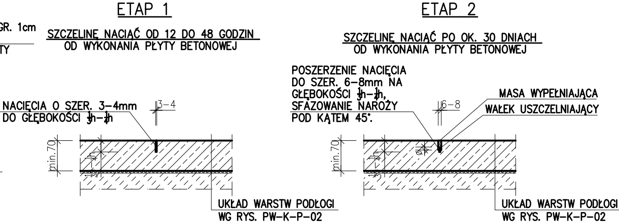
DETAL NR 3 DETAL DYLATACJI SKURCZOWEJ SKALA 1:10
